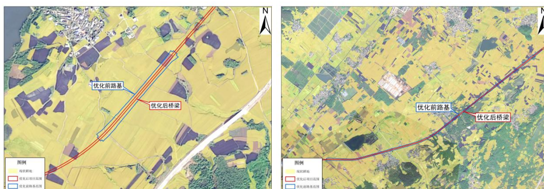
图 3 路基改桥梁优化前后示意图
